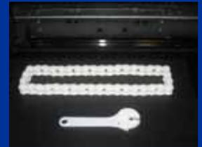
紫外線硬化性樹脂をインクジェット方式で噴射し、紫外線ランプで硬化させながら積層します。試作品を手軽にたくさん作れるので、試作における製造コストの削減と製作時間の短縮につながります。
